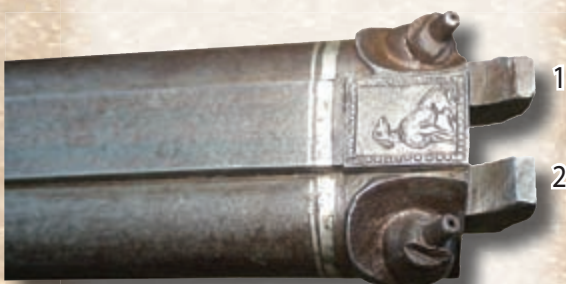
Фото 55. Ствольные задние крепежные крюки (1, 2)
