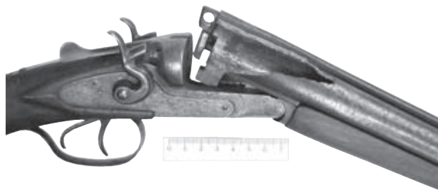
Фото 1106. Последствия стрельбы бездымным порохом с давно истекшим сроком хранения. Это продолжение
